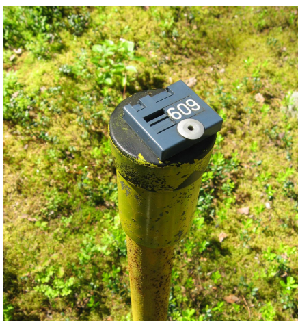
Kuva 3. Tunnuksella merkitty havaintoputki.
